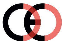
Falsk CE-mærke (for tæt på hinanden)
